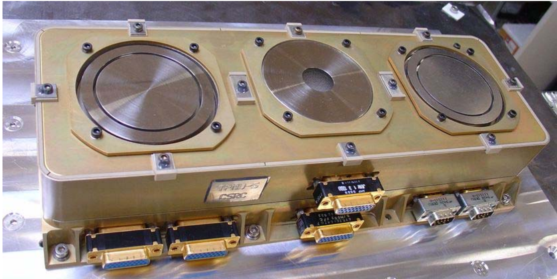
Obr.1. Přístroj TPMU v letovém provedení, rovinná čidla jsou umístěna na horní straně přístroje, konektory pro připojení do telemetrického systému družice a připojení čidel DSLP jsou na přední boční straně.
